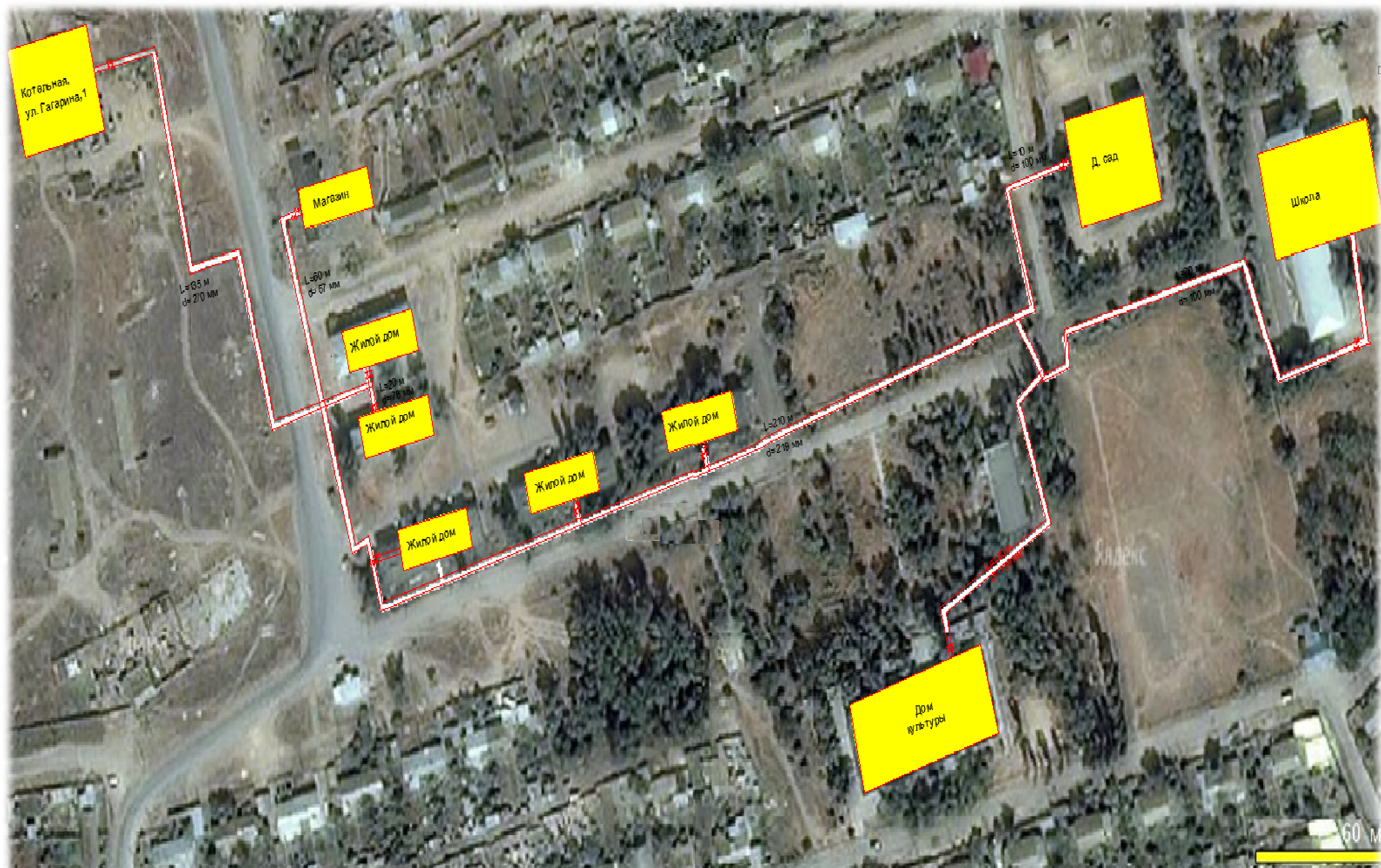
Карта населенного пункта с сайта Google с расположением потребителей и обозначением диаметров трубопроводов.
